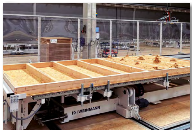
Vollautomatisches Einbringen von losen Dämmmaterialien
