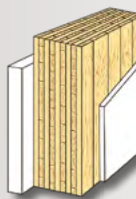
Außenwand 9 Lagen entspricht 20,5 cm
