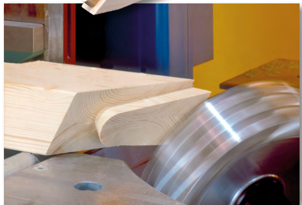
Bearbeitungsvielfalt durch vollautomatischen Abbund.
