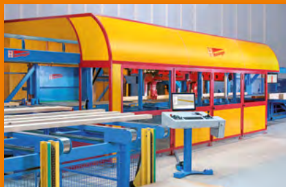
Stab- und Plattenabbund
