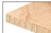
**Stäbchensperrholz** aus geschälten und vollverleimten Fichten-, Pappel- oder Überseegehölzern mit aufrechtstehenden Jahresringen für ein gleichmäßiges Schwindverhalten. Dadurch wird eine hohe Oberflächenqualität erzeugt.
